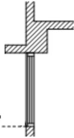
左圖開窗上緣僅有 70% 部分覆蓋水平遮陽版，則  $K_i' = 1 - (1 - K_i) \times 70\%$ 。
