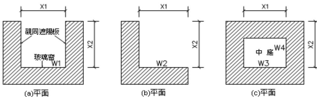
W1、W2、W3整體外牆之開窗玻璃部分均以深度比= $X2/X1$  遮蔽角度計算  $K_i$  值，但(b)圖W2外牆因僅具一側翼，因此其遮陽效果應予折半計算，即  $K_i = (1 + \text{表 5-2 查得之 } K_i) / 2$
