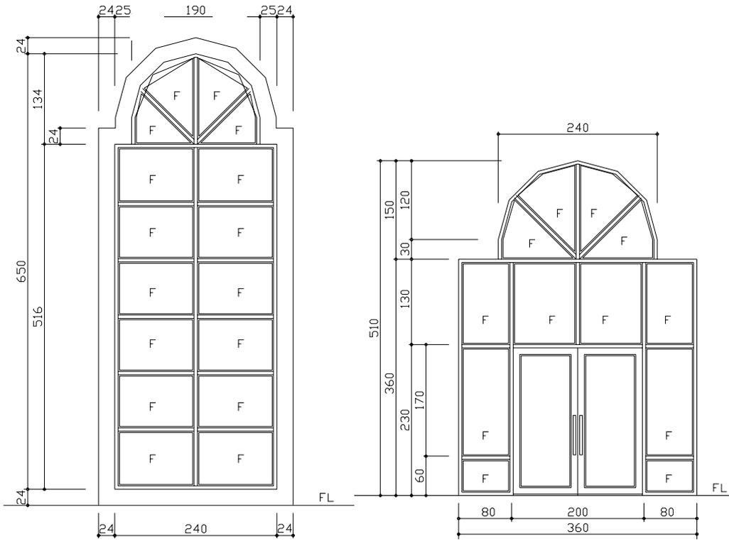
SW 8 240×650 不鏽鋼落地門 五金配件齊全 裝配 10mm 膠合安全玻璃
