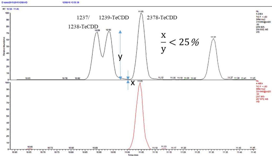
圖一、2,3,7,8-TeCDD 在 TG-Dioxin 層析管柱之解析度
