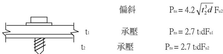
圖 C-11.4-4 對於  $t_2/t_1 \leq 1.0$  的設計公式
