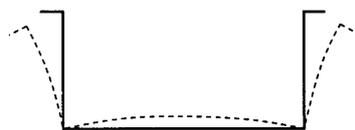
圖 C-6.2-6 U 型斷面梁之側向挫屈
