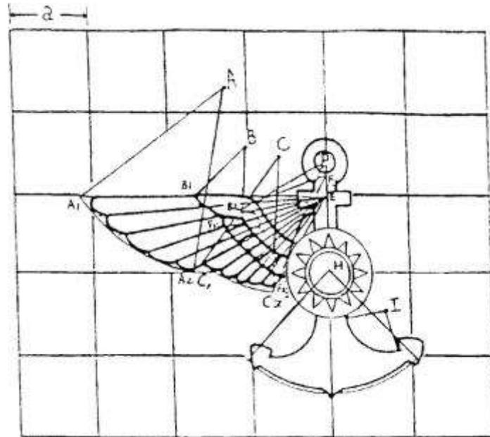
1. 以ABCDF 為圓心，以 $2.2a$ ， $0.9a$ ， $1.7a$ ， $1.6a$ ， $1.2a$ ，各為半徑畫弧即得  $A_1A_2B_1B_2C_1C_2D_1D_2F_1F_2$ 各緣。
