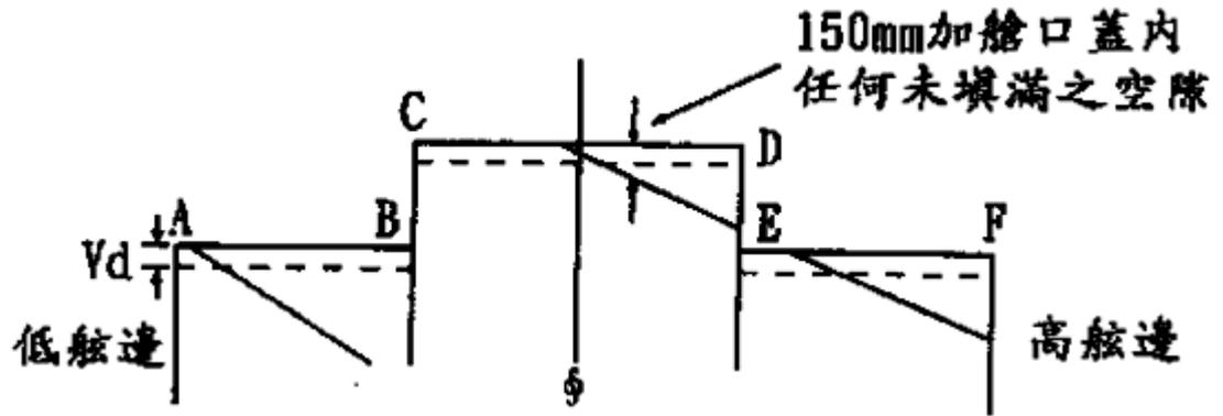
註：1、AB 超過 B 點縱桁材所能形成之任何面積，應移至艙口內之最後空隙面積內。
