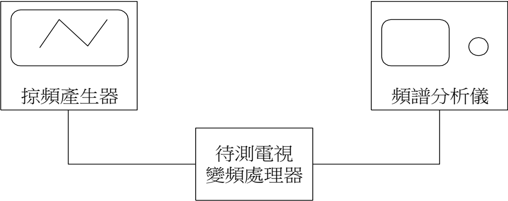
圖 6 頭端電視變頻處理器頻率響應測試裝置
